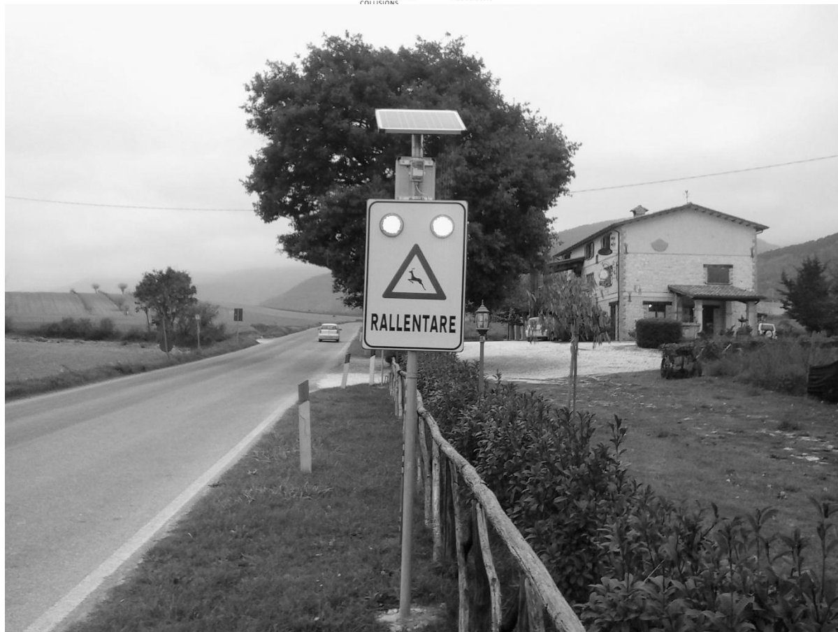
Σχήμα 6. Η προειδοποιητική πινακίδα με αναλάμπουσες λυχνίες, όπως τοποθετήθηκε στην Ιταλία.
