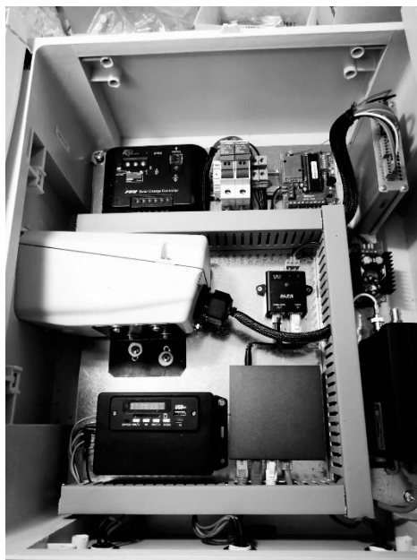
Σχήμα 4. Μέρη/εξαρτήματα της μονάδας ελέγχου
