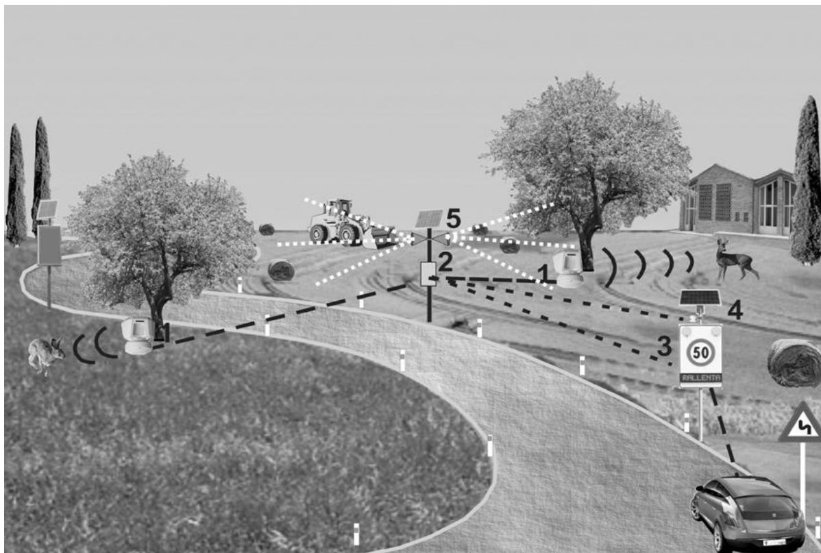
Σχήμα 1. Εξαρτήματα και μέρη του συστήματος AVC πρόληψης ατυχημάτων.
